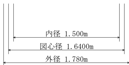
図1.1.1 本管断面形状及び開口位置
