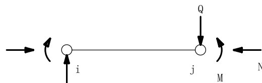
図2.7.1 断面力の正方向
