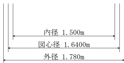
図1. 1. 1 本管断面形状及び開口位置
