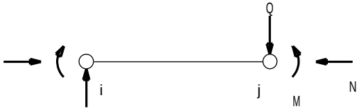
図2.7.1 断面力の正方向
